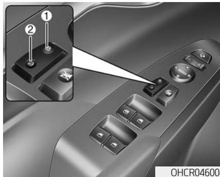
При нажатии на кнопку (🔒) (1) переключателя производится блокирование всех дверей.
