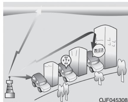
AM и FM радиосигналы передаются с высотных радиопередатчиков, расположенных вокруг города. Они улавливаются радиоантенной вашего автомобиля. Затем этот сигнал передается радиоприемником в динамики автомобиля.
