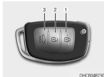
Для блокирования дверей нажмите кнопку блокирования дверей (1) на дистанционном ключе.
