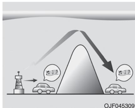
Сигнал AM передается на большее расстояние, чем сигнал FM. Это происходит потому, что радиоволны AM диапазона передаются на низких частотах. Эти радиосигналы с большой длиной волны и низкой частотой распространяются не по прямой линии в атмосфере, а могут огибать земную поверхность. Кроме того, они огибают препятствующие их распространению объекты, что обеспечивает лучший прием сигнала.
