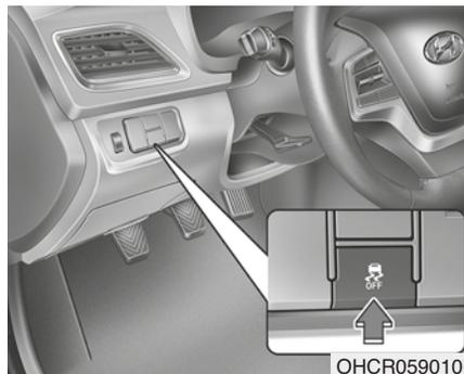
Электронная система динамической стабилизации (ESC) способствует сохранению устойчивости автомобиля на поворотах.
