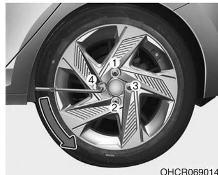
6. Ослабьте против часовой стрелки гайки крепления колеса, но не откручивайте их полностью, пока колесо не будет поднято над землей.
