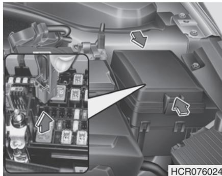
все электрические системы. Если предохранитель перегорел, извлеките его и установите новый с таким же номинальным током при помощи съемника, предусмотренного для этой цели в блоке предохранителей в моторном отсеке. Там же имеются запасные предохранители.
