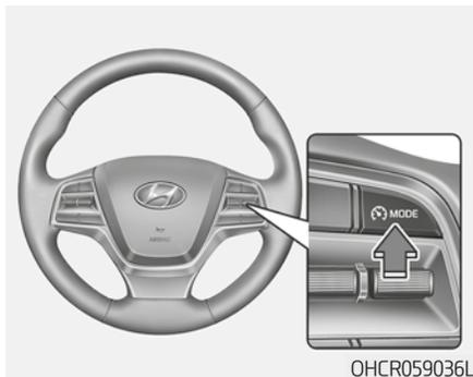
1. Для включения ФУНКЦИИ нажмите кнопку / MODE на рулевом колесе. Контрольная лампа круиз-контроля загорается.
