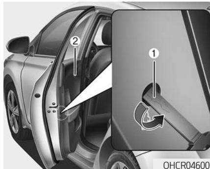
Устройство блокировки замков задних дверей предназначено для предотвращения их случайного открывания детьми, находящимися внутри автомобиля. Устройство блокировки замка для защиты детей должно использоваться всегда, когда в автомобиле находятся дети.
