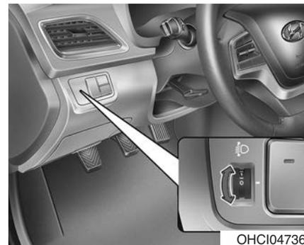
Для регулировки наклона фар в соответствии с количеством пассажиров и весом груза в багажнике следует повернуть ручку регулятора угла наклона фар.
