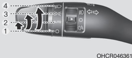
Для управления осветительными приборами поверните ручку на торце подрулевого переключателя в одно из следующих положений:
