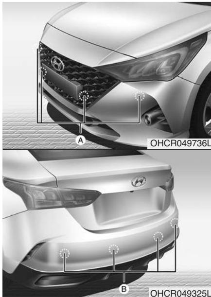
[A] : Передний датчик, [B] : Задний датчик
