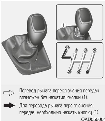
В механической коробке передач предусмотрено 6 передач переднего хода. Трансмиссия полностью синхронизирована на всех передачах переднего хода, поэтому переключение легко осуществляется как на повышенные, так и на пониженные передачи.
