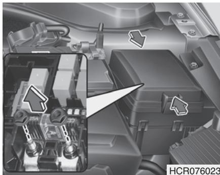
Перегоревший мультипредохранитель извлекают следующим образом:
