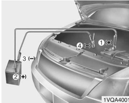
4. Присоедините кабели для запуска двигателя от внешнего источника (пусковые кабели), строго следуя указанной на рисунке последовательности. Сначала подсоедините один конец пускового кабеля к красному плюсовому (+) выводу разряженной АКБ (1).
