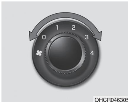
Для работы вентилятора ключ в замке зажигания должен находиться в положении ОП.
