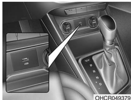
Для подключения портативных аудиоустройств могут использоваться разъемы USB.
