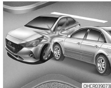
Передние подушки безопасности могут не раскрыться при боковых столкновениях, поскольку происходит перемещение находящихся в автомобиле людей в направлении столкновения и, таким образом, при боковых столкновениях раскрытие передних подушек безопасности не обеспечивает дополнительной защиты.
