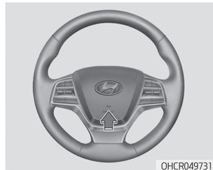
Для включения звукового сигнала нажмите на зону на рулевом колесе, обозначенную соответствующим символом (см. рисунок). Звуковой сигнал будет работать только во время нажатия на эту зону.
