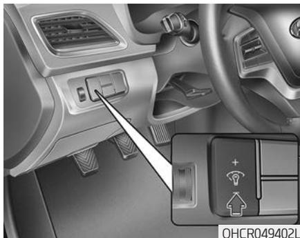
Когда на автомобиле включены габаритные огни или передние фары, используйте кнопку регулировки настройки подсветки для изменения яркости подсветки приборной панели.
