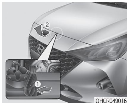
3. Подойдите к автомобилю спереди, приподнимите капот, потяните за вторичную защелку (1) по центру под капотом и откройте капот (2).
