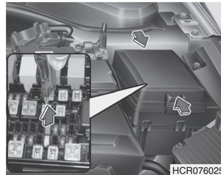
Перед проверкой предохранителя следует выключить двигатель и все электрические системы. Если предохранитель перегорел, извлеките его и установите новый с таким же номинальным током. При снятии соблюдайте осторожность, чтобы не повредить плавкий предохранитель.
