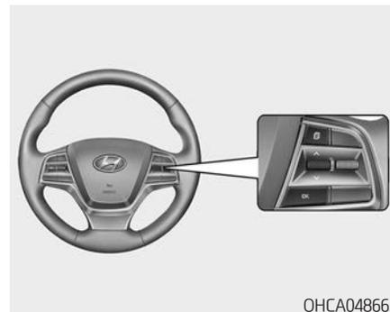
Для изменения режима суточного пробега нажмите кнопку TRIP на рулевом колесе.
