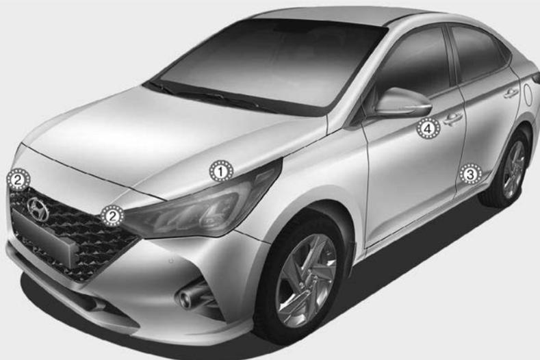
1. Модуль управления SRS / Датчик опрокидывания\*
