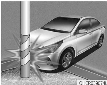
Подушки безопасности могут не раскрыться при столкновении автомобиля со столбом или деревом, когда удар сконцентрирован в одном месте, и энергия столкновения поглощена структурой транспортного средства.
