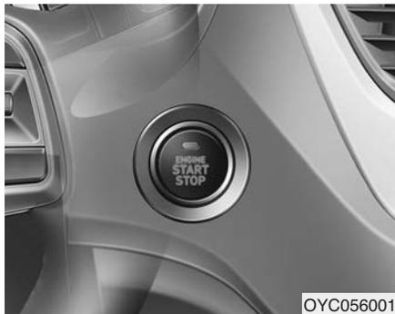
загорается подсветка кнопки пуска/остановки двигателя. Через 30 секунд после закрывания двери подсветка гаснет (при наличии).
