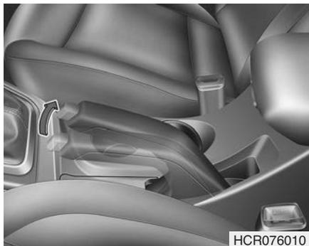
Проверьте ход рычага стояночного тормоза, подсчитав количество щелчков, слышимых при полном его включении из выключенного положения. Кроме того, стояночный тормоз должен независимо от других устройств надежно удерживать автомобиль на достаточно крутом склоне. Если ход отличается от требуемого, рекомендуем обратиться к авторизованному дилеру HYUNDAI для проверки системы.
