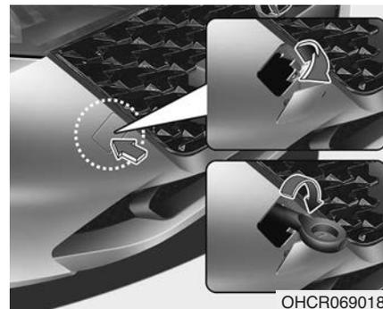
2. Снимите крышку с отверстия в бампере, нажав на нижнюю часть крышки.
