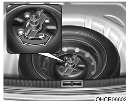
Вращайте барашковый прижимной болт против часовой стрелки для снятия запасного колеса.
