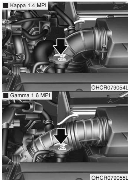
Проверьте состояние всех шлангов систем охлаждения и обогрева, а также их соединения. Замените все изношенные или имеющие вздутия шланги.
