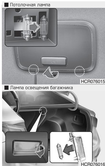
1. С помощью шлицевой отвертки аккуратно подденьте и извлеките рассеиватель из корпуса плафона освещения салона.
