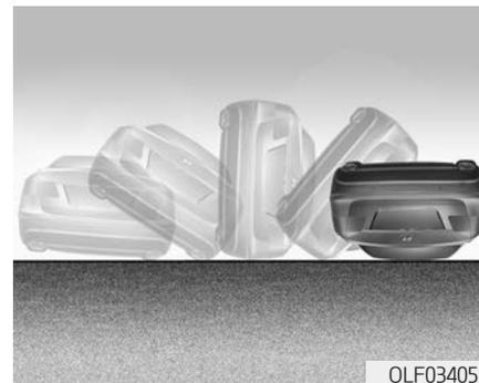
Передние подушки безопасности не раскрываются при переворачивании автомобиля, поскольку они не обеспечивают защиту пассажиров при таких авариях.
