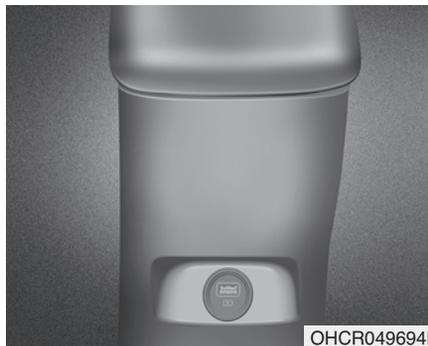
Зарядное USB -устройство предназначено для зарядки батарей небольших электрических гаджетов через USB-кабель.
