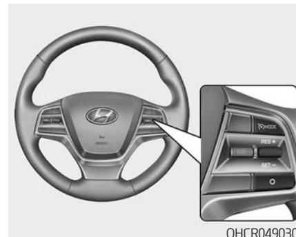
Для изменения режима суточного пробега нажмите переключатель « $\wedge$ ,  $\vee$ » на рулевом колесе.
