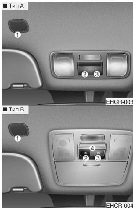
Элементы системы ЭРА-ГЛОНАСС, установленные в салоне автомобиля:
