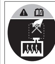
**НЕ СЛЕДУЕТ** открывать крышку радиатора или выкручивать сливную пробку, если двигатель еще не остыл. Может произойти выброс горячей охлаждающей жидкости и пара под давлением, что может стать причиной серьезной травмы.
