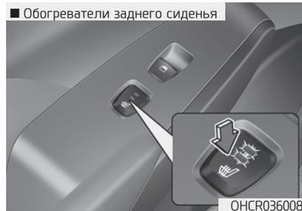
При работающем двигателе включите обогреватель сиденья водителя или пассажира.
