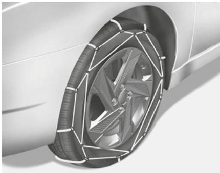
Поскольку боковины радиальных шин тоньше, чем у шин других типов, они могут быть повреждены при установке цепей противоскольжения. Поэтому вместо цепей противоскольжения рекомендуется использовать зимние шины. Не устанавливайте цепи противоскольжения на автомобили с алюминиевыми дисками. Если же это необходимо, используйте цепи тросового типа. При необходимости использования цепей противоскольжения используйте оригинальные детали HYUNDAI или подходящий для автомобиля эквивалент, а мон-
