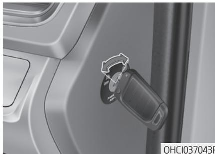
**Переключатель ОП/OFF (Вкл./выкл.) передней подушки безопасности пассажира (при наличии)**
