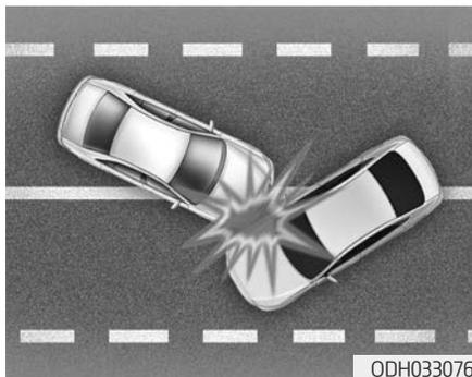
При угловом столкновении силой удара люди могут быть направлены в таком направлении, при котором подушками безопасности не будет обеспечиваться дополнительная защита и, таким образом, датчиками может не подаваться команда на раскрытие подушек безопасности.
