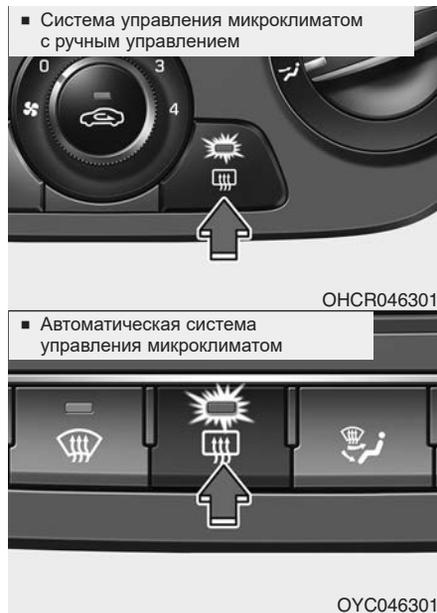
При работающем двигателе обогреватель нагревает заднее окно изнутри и снаружи для устранения инея, запотевания и ледяного налета.
