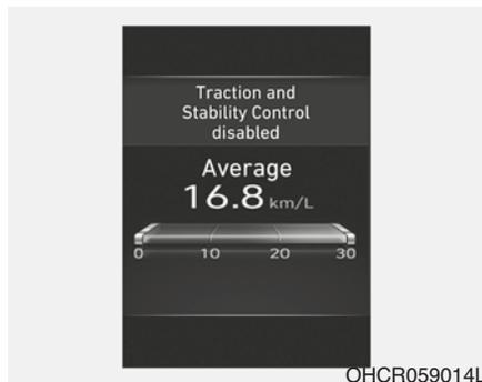
Нажмите кнопку ESC OFF и удерживайте ее не менее 3 секунд. Загорится индикатор ESC OFF, появится соответствующее сообщение (на автомобиле с дисплеем комбинации приборов) и включится сигнальный зуммер. В этом состоянии и функция контроля тягового усилия ESC (управление двигателем) и функция контроля тормозной системы ESC (управление торможением) деактивируются.
