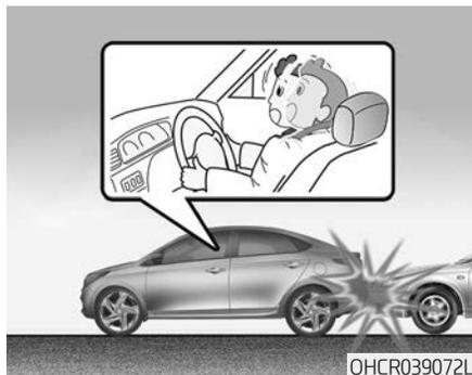
Передние подушки безопасности не рассчитаны на раскрытие при ударах сзади, так как водитель и пассажиры перемещаются назад под воздействием силы столкновения. В этом случае подушками безопасности не обеспечивается дополнительная защита.
