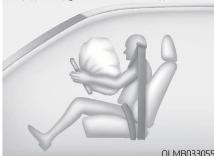
После срабатывания происходит разрыв швов мягкой крышки, которая отделяется под давлением при расширении подушек безопасности. Последующее открытие крышек позволяет полностью раскрыться подушкам безопасности.
