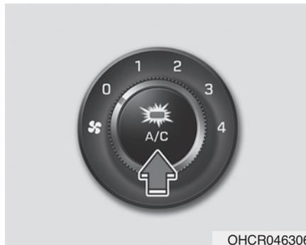
Для включения системы кондиционирования нажмите кнопку A/C (при этом загорится расположенный в ней индикатор). Повторное нажатие на эту кнопку приводит к выключению системы кондиционирования.
