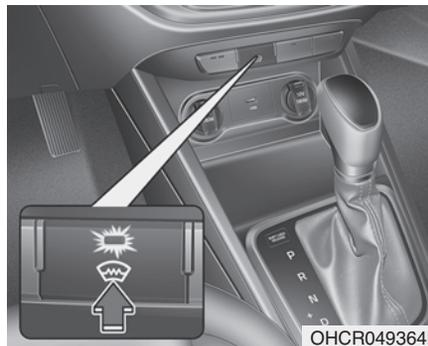
При работающем двигателе обогреватель нагревает ветровое стекло изнутри и снаружи для устранения инея, запотевания и ледяного налета.
