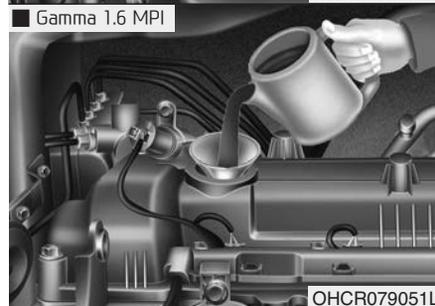
Для предотвращения разлива масла на элементы двигателя используйте воронку.
