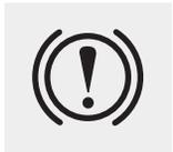
Поверните выключатель зажигания в положение ОП (не запуская двигатель) и проверьте, горит ли контрольная лампа стояночного тормоза.
