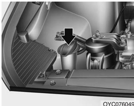
Бачок выполнен полупрозрачным, что позволяет визуально оценить уровень жидкости при беглом осмотре.
