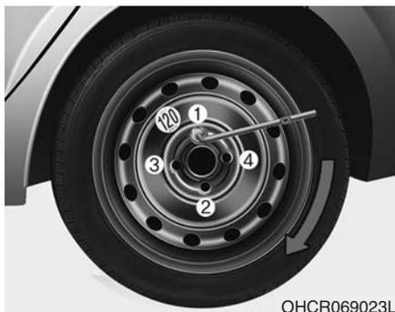
13. С помощью ключа для колесных гаек закрутите гайки крепления колеса в показанной последовательности. Выполните повторный контроль затяжки каждой гайки. После замены колес рекомендуется как можно скорее обратиться к авторизованному дилеру HYUNDAI для затяжки колесных гаек с надлежащим моментом затяжки. **Момент затяжки гаек крепления колеса — 11–13 кгс·м (79–94 фунт-сила-фут).**
