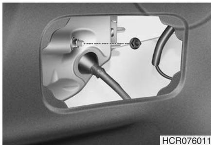
3. Открутите гайки крепления узла.
