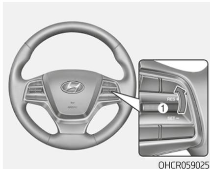
Толкните рычаг (1) вверх (к RES+). Если скорость автомобиля превышает 40 км/ч (25 миль/ч), функция восстанавливает ранее заданную скорость движения.
