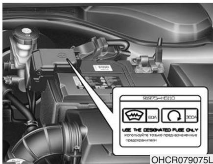
С внутренней стороны крышки блока реле и предохранителей находится этикетка с указанием названий предохранителей и их номинала
