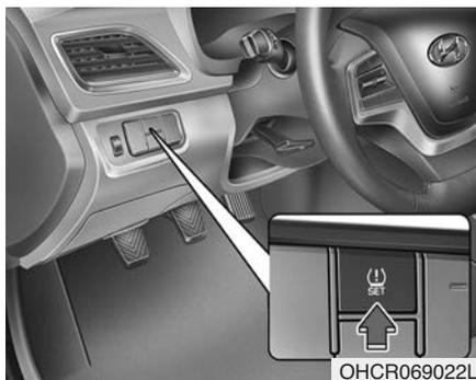
Процесс сброса выполняется автоматически. Затем необходимо убедиться, что индикатор низкого давления в шинах погаснет после мигания в течение четырех секунд.
