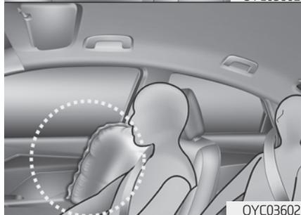
Данный автомобиль оснащен боковыми подушками безопасности в каждом переднем сиденье. Подушки безопасности предназначены для дополнительной
