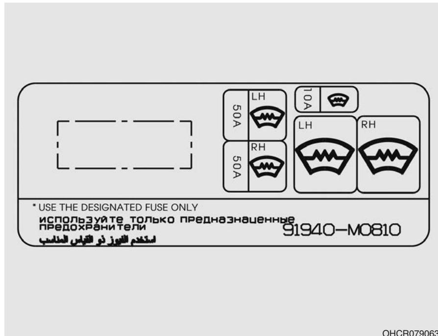
ны на момент публикации. При проверке блока предохранителей следует использовать табличку, нанесенную на крышку блока предохранителей.
