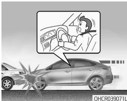
При определенных столкновениях на низкой скорости возможно, что подушки безопасности не раскроются. Подушки безопасности не рассчитаны на раскрытие в подобных случаях, так как ими не будет обеспечиваться дополнительная защита, помимо обеспечиваемой ремнями безопасности.
