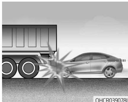
Непосредственно перед столкновением водители часто сильно нажимают на педаль тормоза. При таком торможении передняя часть автомобиля опускается, и он может «заехать» под транспортное средство с более высоким дорожным просветом. В подобной ситуации подушки безопасности могут не раскрыться, поскольку зафиксированная датчиками интенсивность замедления может быть значительно уменьшена.
