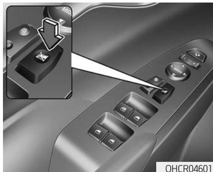
Водитель может заблокировать переключатели электростеклоподъемников задних дверей, нажав выключатель блокировки. Когда выключатель блокировки электростеклоподъемников нажат:
