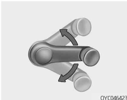
Поднятие или опускание стекла осуществляется поворотом рукоятки стеклоподъемника по часовой стрелке или против часовой стрелки с правой стороны. С левой стороны — в противоположном направлении.
