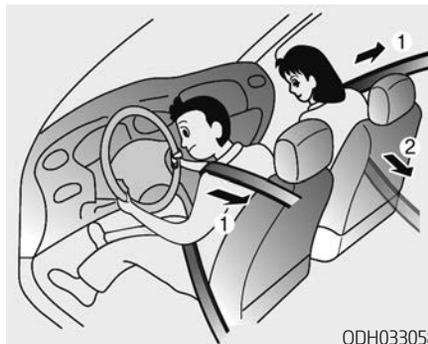
Автомобиль оборудован устройствами предварительного натяжения ремней безопасности (преднатяжителями) для сидений водителя и переднего пассажира. Преднатяжитель предназначен для натяжения ремня и удержания тела водителя или пассажира при лобовом столкновении. Преднатяжители ремней безопасности могут срабатывать одновременно с подушками безопасности при достаточно серьез-
