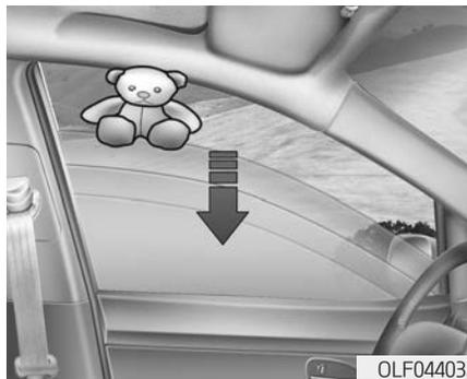
Если при автоматическом закрытии окна, стекло упрется в препятствие, оно остановится и опустится примерно на 30 см (12 дюймов), давая возможность извлечь объект.
