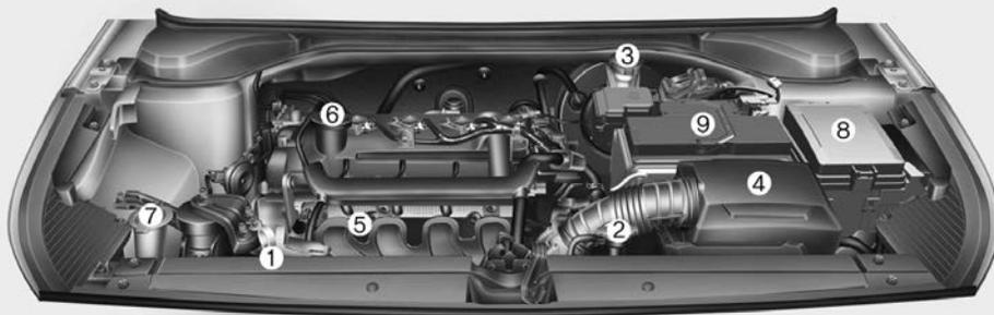
1. Расширительный бачок для охлаждающей жидкости двигателя
