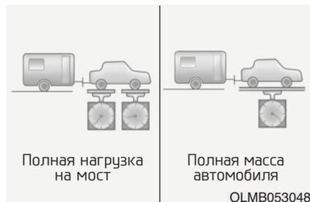
Нагрузка на дышло прицепа имеет большое значение, поскольку влияет на полную массу автомобиля. Нагрузка на дышло прицепа не должна превышать 10% от полной массы прицепа, загруженного в пределах максимально допустимой нагрузки на дышло.
