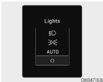
Этот индикатор отображает, варианты выбора включенных приборов наружного освещения с помощью переключателя внешними световыми приборами.
