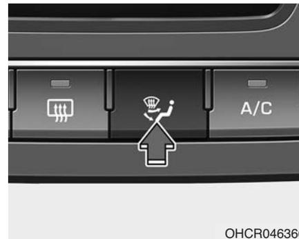
Кнопка выбора режима распределения воздуха управляет направлением потоков воздуха через систему вентиляции.
